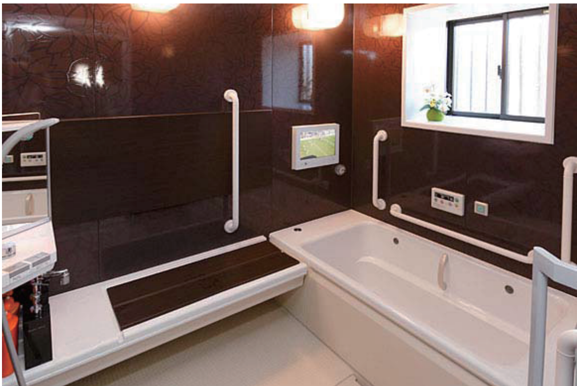
手すりや腰掛けなど、使いやすいに配慮したバスルーム。 車椅子対応の多目的洗面台。
